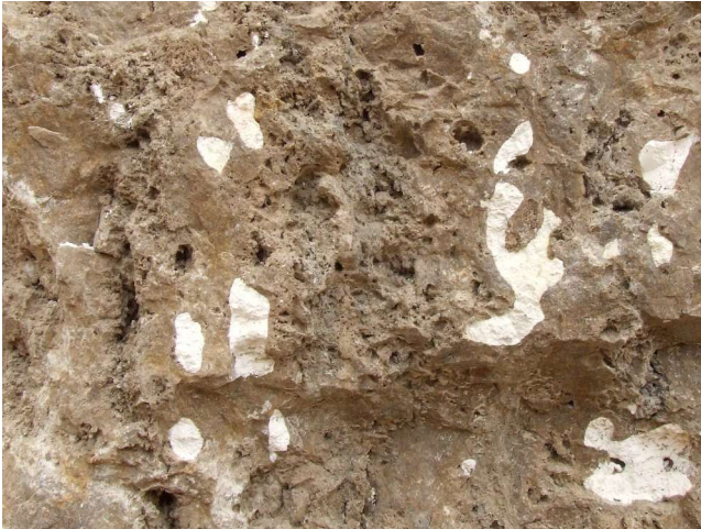
Abb. 6: Poröse Bereiche können auch durch Entkalkung von Hornsteinen und Ausspülung der Rückstände erfolgen. Im Bild ein hornsteinreicher Dolomit mit hoher Porosität durch teilweise bereits entfernte Hornsteine sowie zusätzlicher Vergrusung. Letztere erscheint um die entfernten Hornstein herum intensiviert. Steinbruch Ammelhofen östl. Neumarkt, Oberpfalz, Mittlere Frankenalb). Bildbreite ca. 40 cm.
