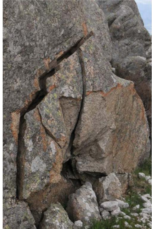
Abb. 5: Die meisten auf Gesteinsoberflächen entwickelten Krusten sind eine Kombination aus mineralischen und biogenen Komponenten. In diesem Fall ist die Oberfläche von Bakterien und Flechten besiedelt, wozu aber nach innen hin eine – an der rötlichen Färbung erkennbare – Zementation mit Eisenoxiden kommt. Die Kruste unterstützt den Zusammenhalt der Gesteinsoberfläche, kann aber auch wieder zerstört werden. Mte. Limbara (Sardinien).
