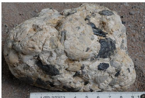
Abb. 28: Silcrete-Brekzie, aus unterschiedlich stark limonitisierten Komponenten, darunter auch kantige Lydit-Stücke. Die Matrix ist sehr stark ausgebleicht, das Gestein hat erheblich an Dichte verloren. Lok. Greuth.
