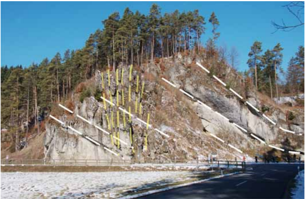
Abb. 10: Trennflächen im Dolomitmfels. Weiß markiert: Schichtflächen. Die relativ steil nach rechts (Osten) geneigten Flächen sind Indiz für eine Position am Rand eines kuppelförmigen Massenfazies-Vorkommens („Riff“). An den Fugen hat bereits eine deutliche Unterhohlung stattgefunden; an vielen Stellen tritt Sickerwasser aus. Abgesehen von der starken Schichtneigung zeigt dieser Fels die charakteristische Erscheinungsform der als tafelbankig bezeichneten Dolomit-Fazies. Gelb markiert: nahezu senkrechte Kluftflächen, die in einer Schar gebündelt den Fels durchschlagen. Solche Flächen fungieren prinzipiell als Anlage für die Zerteilung einer Felsgruppe in einzelne Türme. Wenn die Kluftabstände allerdings so eng angeordnet sind wie in diesem Fall, wird vermutlich die gesamte Kluftzone als Ganzes der rascheren Verwitterung zum Opfer fallen und letztlich einen 2-3 m breiten Kluftgang hinterlassen. – Mittleres Kimmeridge am westl. Ortsausgang von Obertrubach („Blechstein“) (GK25 Betzenstein)
