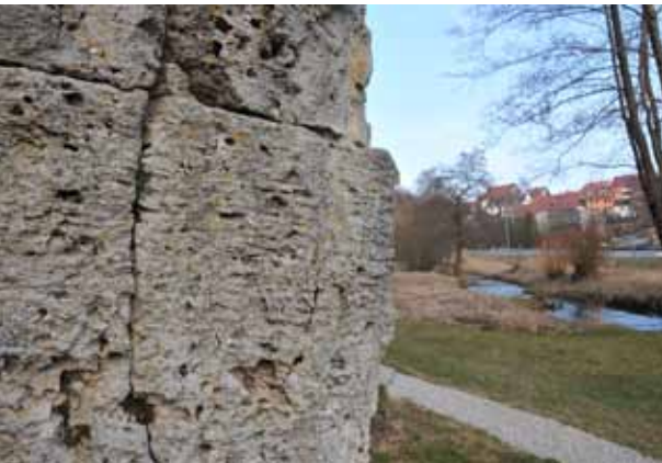
Abb. 33: Strukturierte Kruste auf tafelbankigem Dolomit. Die durch Schwamm-Lagen strukturierte Kruste ist hier schwach mit Bakterien und Flechten besiedelt. Die meisten der kleineren Verwitterungslöcher sind stabilisiert und in die Verkrustung aufgenommen. Einzelne größere Löcher – wie in der Bildmitte unten – scheinen aktiv zu sein, ohne dass allerdings noch Aussickerung erfolgt. – Dolomitstein des Mittleren Kimmeridge, Felsgruppe („Taschnerfelsen“) NE-Ausgang Neuhaus/Aufseß (GK25 Hollfeld)
