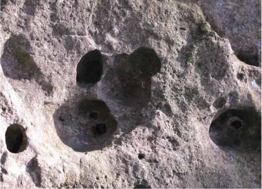
Abb. 16: Kleinräumige Lochverwitterung hat durch Zurücklegung zur Bildung einer Wabenmuster-ähnlichen Gruppe mit zementierten Graten geführt. In diesem Loch wie in einem isolierten zweiten sind kleine Sickerröhren zu sehen, um deren Ausgang sich mit Calcit zementierte Lippen gebildet haben. Diese Entwicklung könnte durch Rückgang an Zuckersäure oder Zunahme an Aridität bestimmt sein. – Vor dem Eingang zur Klauskirche bei Betzenstein, Oberes Kimmeridge (GK25 Betzenstein)
