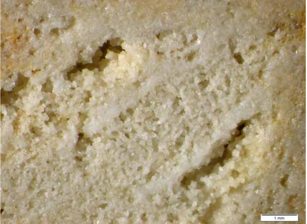
Abb. 8: Detail aus Abb. 7: Die dicht geschlossenen Dolomitlagen repräsentieren die ehemaligen Schwammreste. – Mikroskop-Aufnahme: NORGARD MÜHLDOERFER
