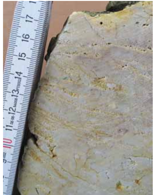
Abb. 7: Ein aus Schwamm-Massenkalk hervorgegangener Dolomit zeigt die hohe Porosität zwischen den Schwammresten (hell) und ehemals thrombolithischen Bereichen (dunklere Ränder, besonders gut im oberen Teil der Probe zu sehen). Die porösen Zonen zeichnen die anfänglichen seitlichen Sickerwege zur Außenseite des Gesteins vor. – Mittleres Kimmeridge, Ortsmitte Obertrubach, Trubachweg Pkt. 2 (GK25 Betzenstein)
