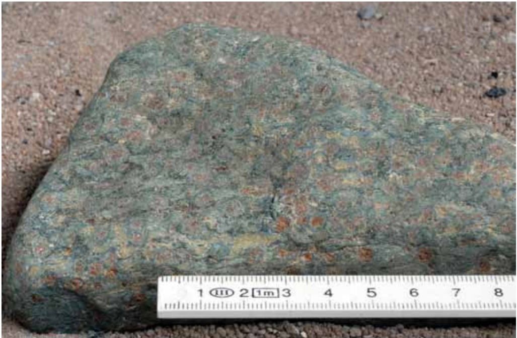
Abb. 5: Eklogit aus der Münchberger Gneismasse, Fundort Büchenbach bei Roth (Sammlung Strickstock, nun NHG). Deutlich erkennbar sind die bis 0,5 cm großen, roten Granate.
