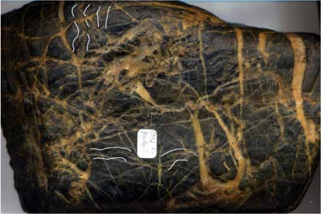
Abb. 3: Charakteristischer Frankenwald-Lydit (vermutlich Silur), Fundort Greuth (Sammlung H. Schreiber, Länge ca. 14 cm). Die bei frischeren Stücken weißen Quarzadern sind durch spätere Imprägnation bräunlich geworden. Der Quarz stammt aus der Gesteinsumgebung selbst, wo er bei tektonischer Beanspruchung durch Drucklösung mobilisiert wurde. Die Drucklösungszonen sind durch filigran gebuchtete Suturen gekennzeichnet (siehe Markierung).
