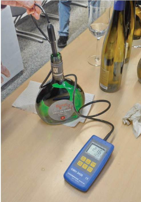
Abb. 17: Im Rahmen der Wein-Verkostung im Seminar 2015 wurde die Leufähigkeit von Weinen mit einem Greisinger 3430 gemessen. Der hohe Wert der meisten Frankenweine – nahezu durchweg über 2mS/cm – überraschte.
